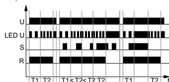
U - напряжение питания; R - состояние выхода реле; S - состояние управляющего контакта; T, T1, T2, T3 - отсчитываемые время; t - ось времени
