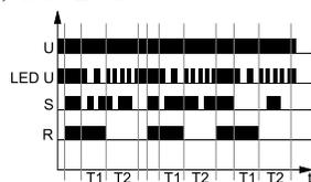
Напряжение питания U должно подаваться на реле времени непрерывно. Включение контакта управления S, включает исполнительное реле R. Выключение контакта управления S, начинает
