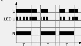
Включение напряжения питания U вызывает немедленное включение рабочего реле R на установленное время T. После отсчета времени T рабочее реле R выключается. Такое состояние длится до момента отключения питания U. Если напряжение U отключается до истечения времени T, то отсчет установленного времени T продолжается, а исполнительное реле R остается включенным до конца времени T, а затем выключается.
